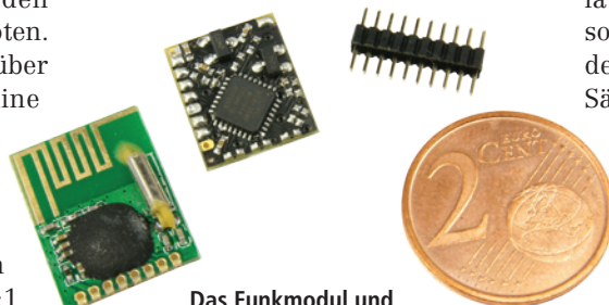
Das Funkmodul und der OpenCar-Decoder werden huckepack mit der Stiftleiste verbunden.
