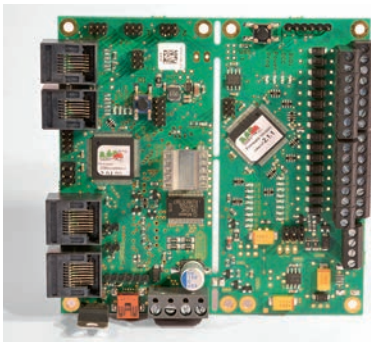
Fichtelbahn-GBMBoost mit BiDiB-Interface, Booster und 16-fachem Belegmelder
