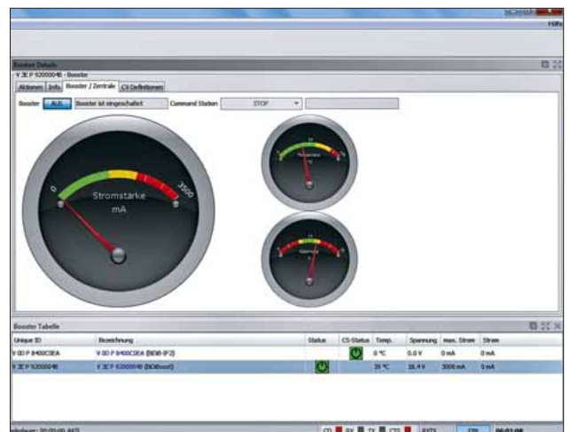
Der Tams-Booster liefert einige interessante Daten wie Spannung, Strom und Temperatur. Die meisten Dinge lassen sich komfortabel über den BiDiB-Wizard einstellen.
