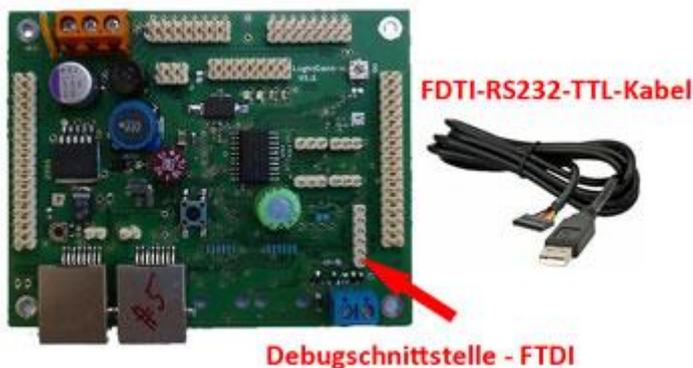
Sie benötigen ein FTDI-RS232-TTL Kabel (kostet 20 Euro) und ein Terminalprogramm (z.B. HyperTerminal bei Windows). Im Gerätemanager ihres Betriebssystems wird das TTL-Kabel als ein neues virtuelles COM-Interface erkannt. Für die Kommunikation mit der LightControl muss die COM-Schnittstelle und das Terminalprogramm auf 115200 Baud und 8N1 betrieben werden.
