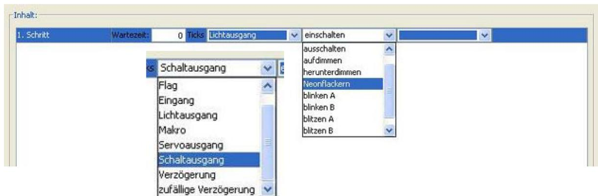
Durch das einfügen von Schritten, zusammenklicken von Ausgangsfunktionen und Wartezeit entsteht Schritt für Schritt ein Makro. Für komplexere Makros oder große Ablaufketten sollte man das Makro in Blöcken zerlegen und durch die Funktion „Makro starten“ mit einander verbinden.
